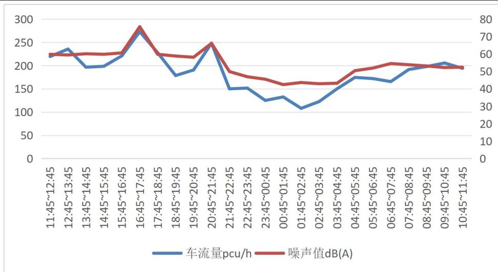
图 11-1 K2+880 处中心线外噪声值及车流量变化图
