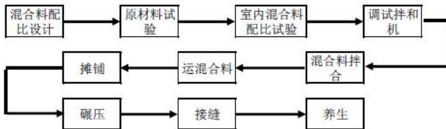
图 4-6 水泥稳定层施工流程图
