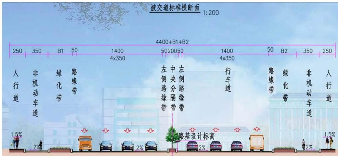
图 2.3-5 S122 改造路段标准横断面
