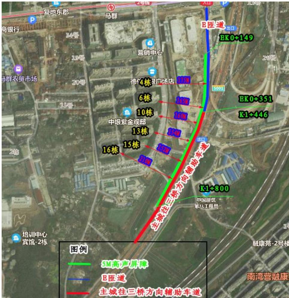
图 5-5 中垠紫金观邸实际声屏障安装图
