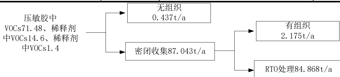
图 3.7-2 VOCs 平衡图 (t/a)
