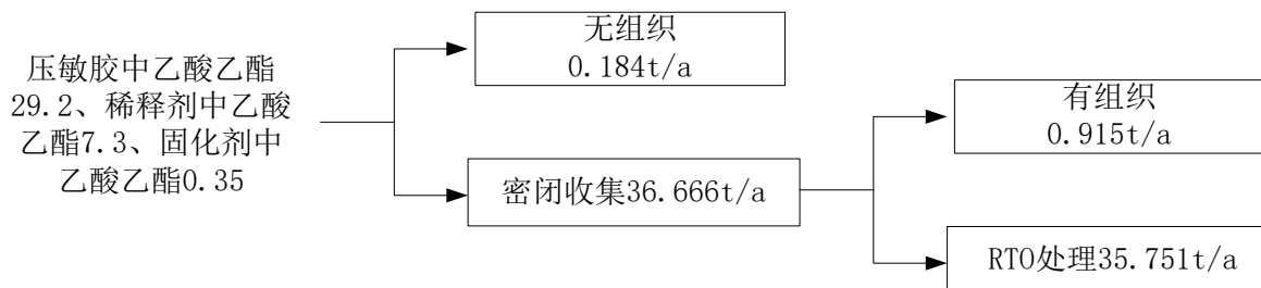
图 3.7-4 乙酸乙酯平衡图 (t/a)
