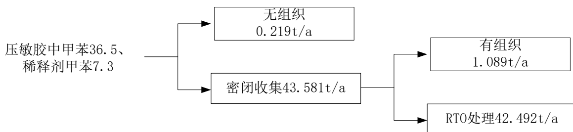
图 3.7-3 甲苯平衡图 (t/a)
