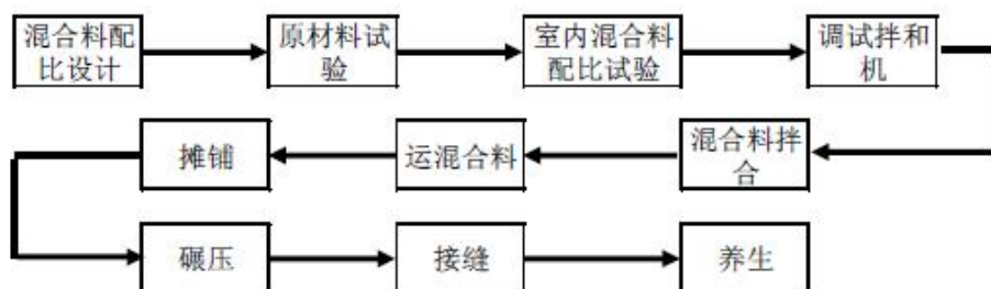
图 4-7 水泥稳定层施工流程图
